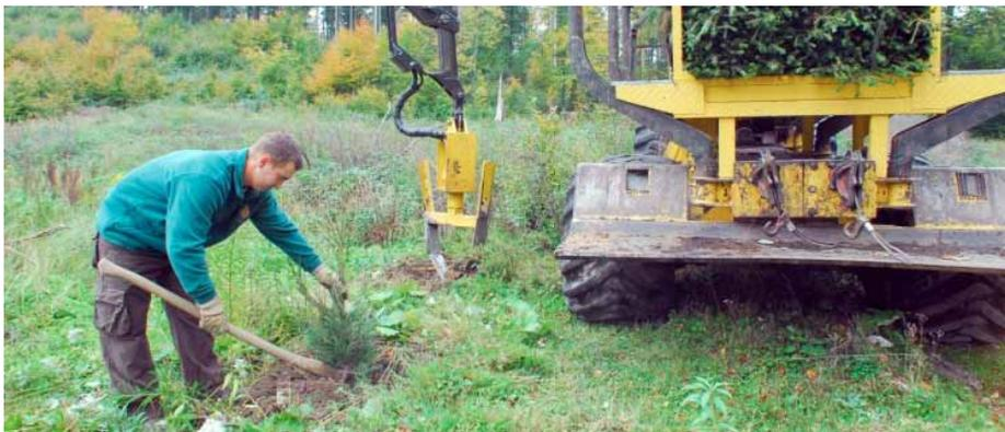
Abb. 3: Teilmechanisierte Pflanzung (Krümmeraggregat am Forwarderarm) mit Großpflanzen (80 bis 120 cm)
